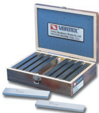
PARALLELUNTERLAGENSATZ 9 PAAR LÄNGE 150MM, BREITE 8,5MM
