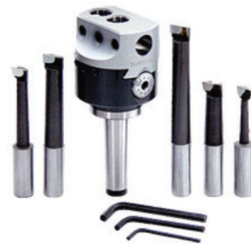
AUSDREHKOPFSATZ, 75MM AUSSENDURCHMESSER, MIT MK4-AUFNAHME UND MEISSELN
