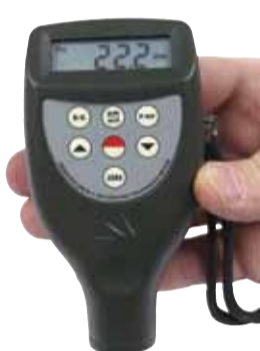
Type HCT-860FNI TIP Mit integrierter Sonde
