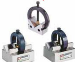
Prismen mit höhenverstellbaren Spannbügeln. Aus gehärtetem Stahl HRC50 gefertigt und paarweise geschliffen. Werden nur als Paar geliefert.
