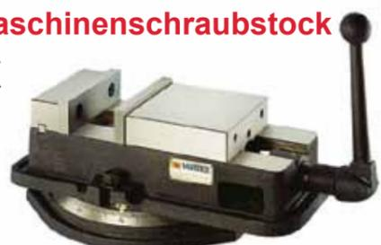
Präzisionsmaschinenschraubstöcke mit abwärts wirkendem Klemmdruck, was verhindert, dass Werkstücke sich bei hoher Klemmkraft nach oben biegen. Mit abnehmbaren Backen sowie gehärteten und geschliffenen Führungen. Ein Drehteller ist standardmäßig im Lieferumfang enthalten.
