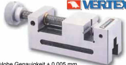
Hohe Genauigkeit ± 0,005 mm. Universell einsetzbar. Völlig gehärtet (HRC 56–58°) und geschliffen. Backe mit senkrechtem und waagrechtem Prisma. Material: SK2.
