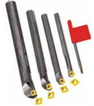
Innendrehmeißelset mit vier Haltern (A08H SCLCR 06, A10J SCLCR 06, A12K SCLCR 06 und A16M SCLCR 06), alle mit Innenkühlung, 10 Wendepplatten CCMT 0602 und Torx-Schlüssel.
