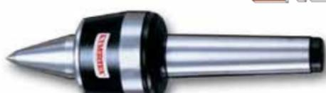
Durch die verlängerte Spitze lassen sich auch schwer zugängliche Werkstücke bearbeiten. Für höhere Drehzahlen geeignet. Die Körnerspitze ist aus einem legierten Stahl (HRC60°+2°) mit hochwertigen Doppellagern gefertigt. Spitzenwinkel 60°. Rundlaufgenauigkeit besser als 0,005 mm. Die Körnerspitze ist wasserdicht.
