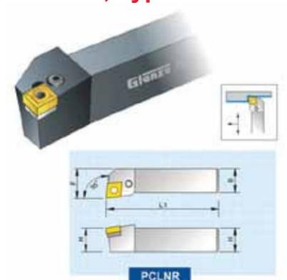
Dieser Drehmeißel entspricht den ISO-Spezifikationen und hat einen Schaft von 20 mm oder 25 mm. Er erfordert eine Wendepplatte vom Typ CNMG 1204.
