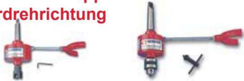
Umkehrbarer Gewindeschneidapparat für Bohr- und Fräsmaschinen. Typ K1 wird mit einem Bohrfutter zum Einspannen kleiner Gewindebohrer verwendet. Die größeren Typen sind mit einer speziellen Aufnahme ausgestattet. Schneidgeschwindigkeit: 1:1
