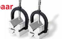
Paarweise geschliffene Prismen mit Bügeln. Hergestellt aus hochwertiger Werkzeugstahl, geschliffen und gehärtet bis 55 - 60 HRC. Die Prismen haben ein Prismenwinkel von 90 Grad. Lieferung einschließlich mit Spannbügel. Genauigkeit Prismen / Seiten 0,025mm. Spannbereich Bügel: 38mm
