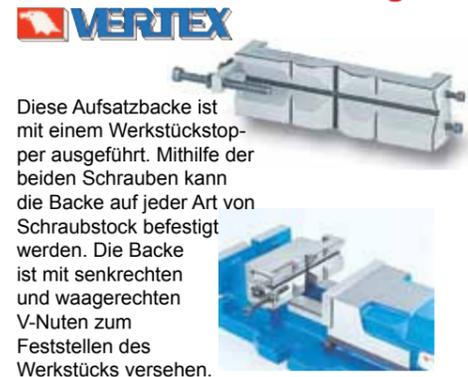
Diese Aufsatzbacke ist mit einem Werkstückstopper ausgeführt. Mithilfe der beiden Schrauben kann die Backe auf jeder Art von Schraubstock befestigt werden. Die Backe ist mit senkrechten und waagerechten V-Nuten zum Feststellen des Werkstücks versehen.
