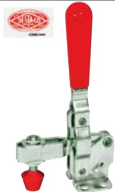
Bei Modellen mit einer Haltekraft von mehr als 1700 Newton sind alle Drehpunkte zur Gewährleistung einer langen Lebensdauer mit Buchsen versehen. Außerdem sind sie zur Minderung von Verschleiß aus hochwertigem nichtrostenden Stahl gefertigt.
