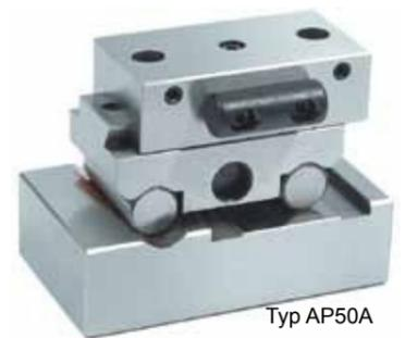
Präzisions- Sinusabrichtwerkzeug zum Abrichten von Schleifscheiben in jedem Winkel von 0 bis 60 Grad. Hohe Genauigkeit. Der Winkel ist mithilfe eines Endmaßes einstellbar.
