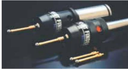
Hochpräzisionsinstrument von NISSIN Japan. Dieser Kantentaster ist mit einem nicht magnetisierbaren Taster ausgestattet, wodurch keine Fehler durch magnetische Anziehung entstehen. Der Taster wird auch nicht magnetisiert, wenn er mit einem magnetisierten Werkstück in Berührung kommt.
