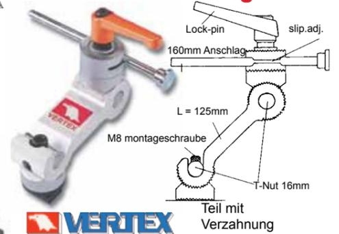
Dieser Anschlag lässt sich schnell und einfach einstellen. Besonders robust und maßstabil, rotierender Teil mit Verzeichnung. Länge des Anschlagstabs: 160 mm, Zwischenarmlänge: 125 mm, Montageschraube: M8 T-Nutenstein: 16 mm
