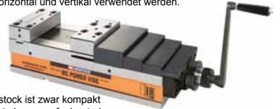
Der Schraubstock ist zwar kompakt ausgeführt, ist aber so aufgebaut, dass eine besonders große maximale Backenöffnungsweite entsteht. Die Spindel ist vor Schmutz und Spänen geschützt. Parallelität: 0,01/100 mm. Toleranz zwischen Bett und Backen: 0,02/100 mm
