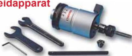
Mit diesem Apparat können die am häufigsten vorkommenden Gewindeschneidarbeiten ausgeführt werden. Zum Gewindeschneiden mit einem Spanbereich von M2 bis M7 und von M4 bis M12. Der Apparat ist selbstzentrierend und verfügt über einen einzigartigen doppelten Federmechanismus mit einer automatischen Geschwindigkeit und einer mildernden Geschwindigkeit. Es gibt zwei Schneidgeschwindigkeiten und zwei Rücklaufgeschwindigkeiten. Mit einem Satz Rubber-Flex-Spannzangen und Bedienungsschlüsseln.
