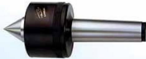
Diese Körnerspitzen sind für die Bearbeitung von besonders schweren Werkstücken bestimmt. Die Körnerspitze ist aus einem legierten Stahl (HRC60°+2°) mit hochwertigen Doppellagern gefertigt. Spitzenwinkel 60°. Rundlaufgenauigkeit 0,006-0,01 mm.
