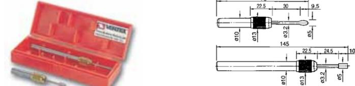
Diese beiden Kantentaster in verschiedenen Längen sind für Drehzahlen von 600 bis 1000 U/min geeignet und bieten dabei eine Genauigkeit von 0,005 mm. Aus Werkzeugstahl gefertigt, gehärtet und geschliffen. Zusammen in einer Kunststoffkiste verpackt. Bei Typ VPS401 besteht die Tastfläche aus Stahl, bei Typ VPS401C aus Keramik.
