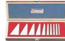
Winkelheerensatz mit Winkeln von 1,2,3,4, 5, 10, 15, 20, 15 und 30 Grad. Leicht magnetisiert für besseren Halt. Aus Stahl gefertigt, gehärtet und präzisionsgeschliffen. Abmessungen: 75x6 mm Genauigkeit: 0,0001" pro Zoll
