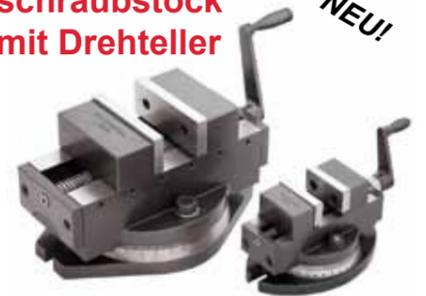
Selbstzentrierender Präzisionsmaschinenschraubstock mit Drehteller. Die Backen wurden präzisionsgeschliffen und auf 55 HRC gehärtet. Der Drehteller verfügt über einen Nonius von 360° und hat eine positive Feststellmöglichkeit. Der Schraubstock zentriert das Werkstück automatisch in der Mitte. Entgegengesetztes Gewinde für eine präzise und schnelle Zentrierung.
