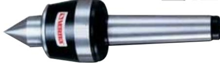
Für höhere Drehzahlen geeignet. Die Körnerspitze ist aus einem legierten Stahl (HRC60°+2°) mit hochwertigen Doppellagern gefertigt. Spitzenwinkel 60°. Rundlaufgenauigkeit besser als 0,005 mm. Die Körnerspitze ist wasserdicht.
