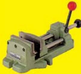
Geschwindigkeit ohne Qualitätsverluste. Auch als ETS-Modell mit flach geschliffenen Seiten oder als UTS-System mit einem Hebel erhältlich.
