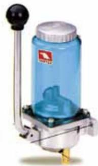
Durch Umlegen des Hebels wird das Öl durch das Rohr gedrückt. Beim Loslassen des Hebels geht dieser automatisch zurück in den geschlossenen Zustand.
