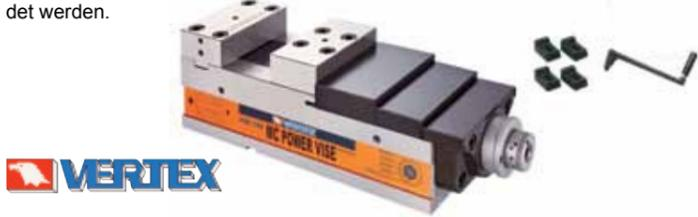
Der Schraubstock ist so aufgebaut, dass eine besonders große maximale Backenöffnungsweite entsteht. Spannkraft mit in fünf Stufen ablesbarem Klemmdruck. Parallelität: 0,01/100 mm. Toleranz zwischen Bett und Backen: 0,02/100 mm
