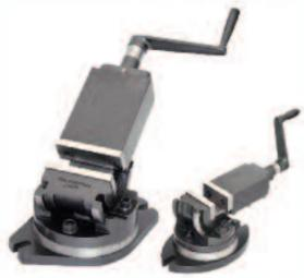
Verstellbarer 2-Wege Präzisions-maschinenschraubstock (kippar und drehbar). Kippmöglichkeit bis 45° zu beiden Seiten mit Nonius-Ableskala. Der Drehteller verfügt über einen 360° Nonius und kann damit in jedem gewünschten Winkel zur vertikalen Achse stehen. Die Backen wurden vollständig gehärtet und mit einer Parallelität von 30 Mikron präzisionsgeschliffen und auf HRC 55 +/-3 gehärtet.
